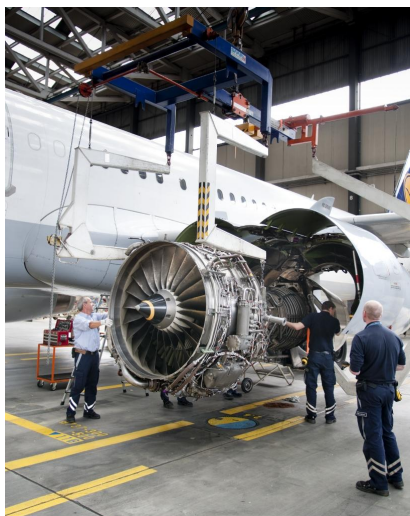
Triebwerkswechsel an einem Airbus A321
